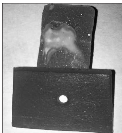
Рис. 1а. Форма с цилиндрическим отверстием для заполнения материалом
