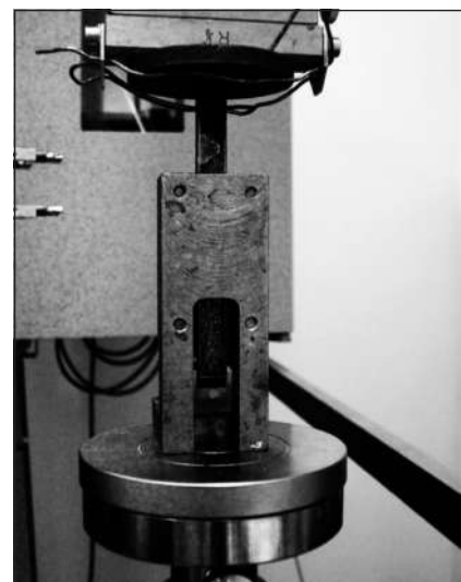
Рис. 2б. Приспособление для испытания адгезионной прочности соединения на сдвиг
