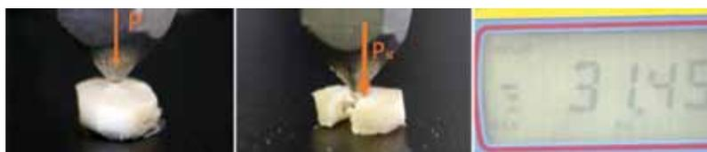
**Рис. 5.** Момент максимальной деформации образца перед разрушением – критическая сжимающая нагрузка – «Pk» фиксировался оператором по показанию динамометра (кгс)
