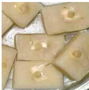
**Рис. 2.** Субстрат (временный зуб) со смонтированным на нем материалом
