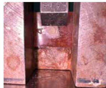
**Рис. 4.** Приспособление для испытания адгезионной прочности соединения на сдвиг с установленным в нем образцом
