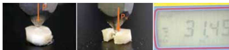
Рис. 5. Момент максимальной деформации образца перед разрушением – критическая сжимающая нагрузка – «Рк» фиксировался оператором по показанию динамометра (кгс) Fig. 5. The moment of maximum deformation of the sample before failure – critical compressive load Pk was recorded by the operator using a dynamometer (in kgf)
