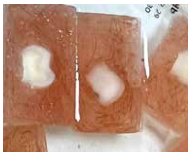
Рис. 1. Субстрат (временный зуб) залитый в монтировочную пластмассу Fig. 1. Substrate (deciduous tooth) embedded in mounting plastic
