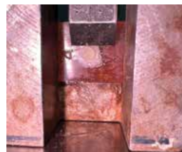
Рис. 4. Приспособление для испытания адгезионной прочности соединения на сдвиг с установленным в нем образцом Fig. 4. Setup for testing the shear adhesive strength of the connection with an installed sample
