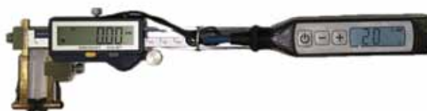
Рис. 6. Электронный позиционер с соосно закрепленными ультразвуковыми преобразователями и адаптационными акустическими манжетами Fig.6. Electronic positioning device with coaxially aligned ultrasonic transducers and custom acoustic cuffs
