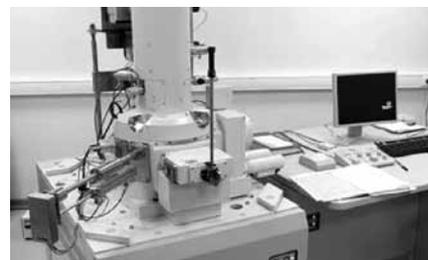
Рис. 3. Растровый сканирующий электронный микроскоп JEOL JSM-6490 LV
