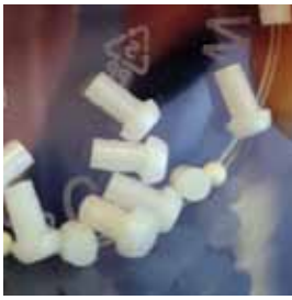
Рис. 1. Образцы из диоксида циркония, цилиндрической формы со шляпкой (источник: составлено авторами)
