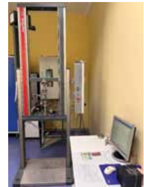
Рис. 3. Испытательная машина Zwick Roell Z 010 (Zwick, Германия) (источник: составлено авторами)
