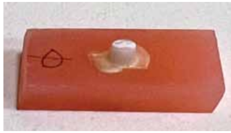
Рис. 2. Субстрат (временный зуб) со смонтированным на нем цилиндром из диоксида циркония (источник: составлено авторами)
