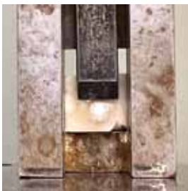
Рис. 4. Приспособление для испытания адгезионной прочности соединения при сдвиге с установленным в него образцом перед испытанием (источник: составлено авторами)
